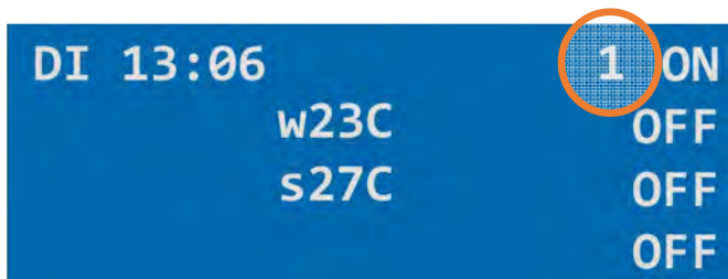
Afbeelding 2. Display met actuele waarden. De 1 in de gele cirkel geeft de actuele pompsnelheid aan.
